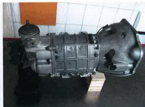
Du côté gauche de la photo, le flector où vient fixé l'arbre de transmission, qui relie la boîte de vitesses au pont arrière.
