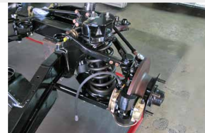
Suspension complète avec ressort à boudin
