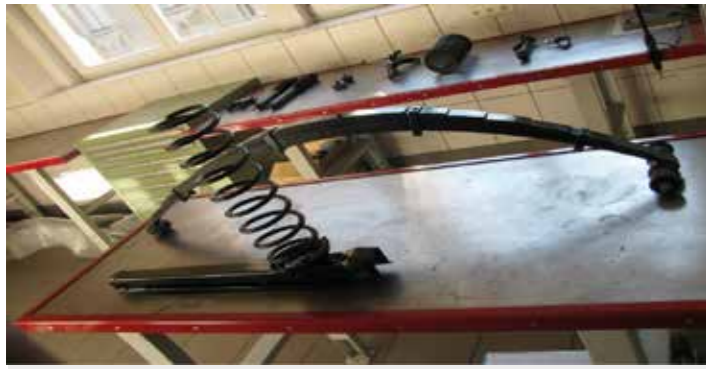
Sur les deux établis, différentes pièces constituant la suspension avant et arrière
