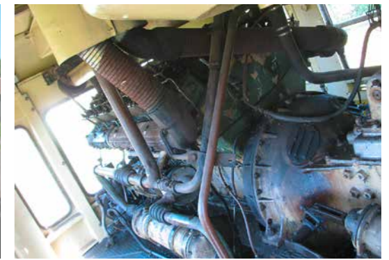
Notre moyen de locomotion avec son moteur et sa boîte de vitesses. Eh oui, une boîte de vitesses à 4 rapports
