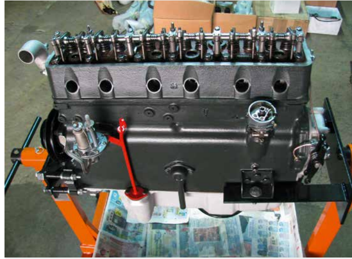
Moteur avec arbre à cames latéral et soupapes en tête avec axe de culbuteurs, culbuteurs et tiges de poussoirs
