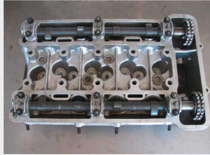
Culasse Alfa Romeo à double arbres à cames en tête et double allumage type 105
