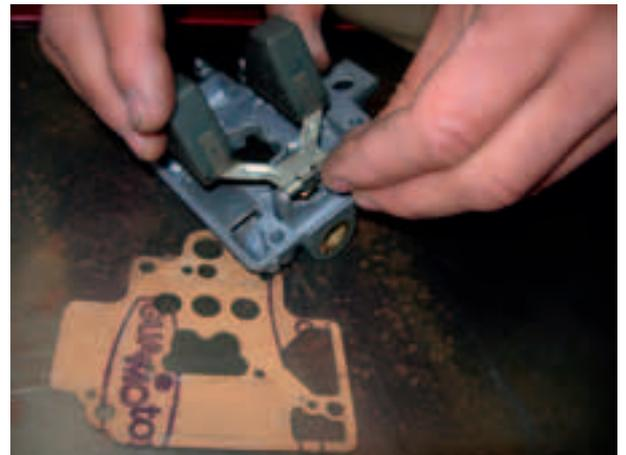
Ici Patrizio en pleine action de contrôle visuel du niveau du flotteur qui devrait être parallèle au plan de joint du couvercle sans actionner le pointeau.
