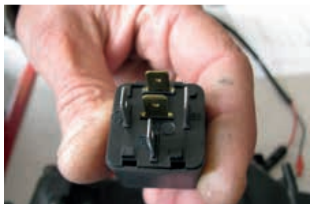
Relais de contact avec numérotation conventionnelle des pôles
